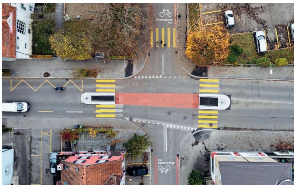
11 | Ein Mehrzweckstreifen an der Kreuzung Tössfeldstrasse/Untere Briggerstrasse soll die Strassenquerung für den Veloverkehr verbessern und das Queren in zwei Etappen ermöglichen.
